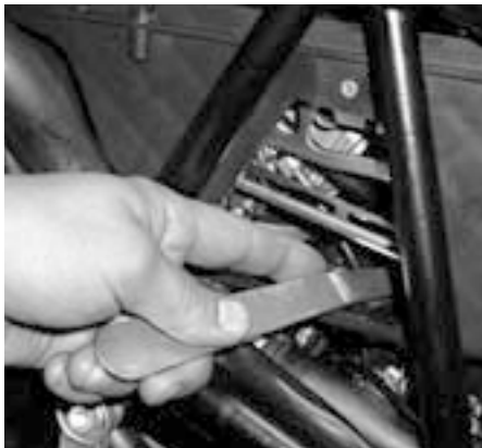
Die Gemischregulierschrauben werden mittels Spezialwerkzeug eingestellt.
