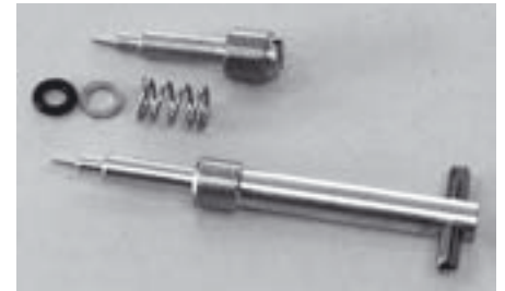
Der ursprünglich verbaute O-Ring, die Schutzscheibe und die Feder werden weiter verwendet. Die neue Tuninggemischschraube ersetzt die kurze Ausführung. Die vorhandene Feder kann um ca. 2 mm auseinander gezogen werden, damit wird die Schraube stärker vorgespannt und vor Verlust geschützt.
