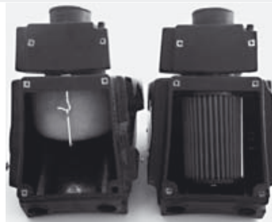
VERGLEICH SERIENLUFTFILTER - KN LUFTFILTER KONIFIZIERTER ALUMINIUMEINSATZ
