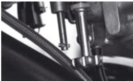
Die Tuninggemischschraube verbleibt im Vergaser und kann schnell und gut zugänglich eingestellt werden.
