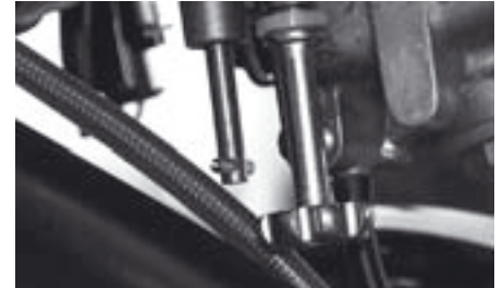
Die Tuninggemischschraube verbleibt im Vergaser und kann schnell und gut zugänglich eingestellt werden
