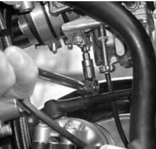
Gemischeinstellung von links per Hand und Biteinsatz oder Spezialwerkzeug.
