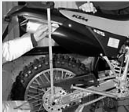
Heck abgebockt = Statischer Durchhang
