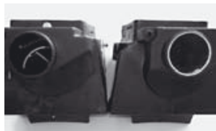
LINKS: „ZERKLÜFTETE“ SERIENLÖSUNG RECHTS: KONSEQUENT KONIFIZIERTE LUFTFÜHRUNG
